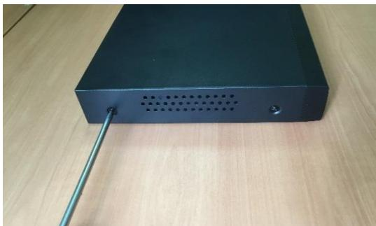
Закрепите HDD к основанию регистратора при помощи винтов через соответствующие отверстия и подключите SATA кабель и кабель питания.
